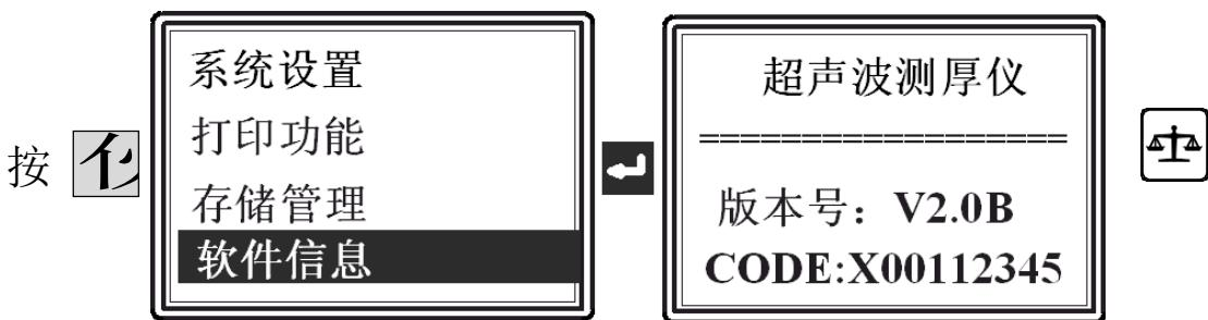
在软件信息的显示下按 **F2** 键后仪器将恢复出厂设置的参数同时自动关机。
