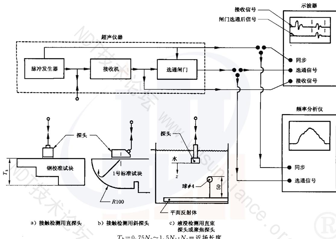
图 1 采用电冲击激励的超声脉冲反射法检测的测试装置
