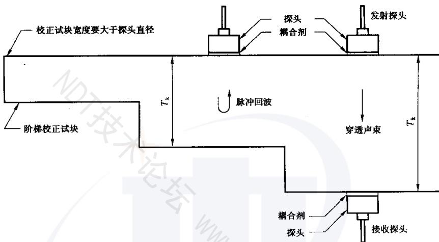
图 3 直探头接触检测的测试布置
